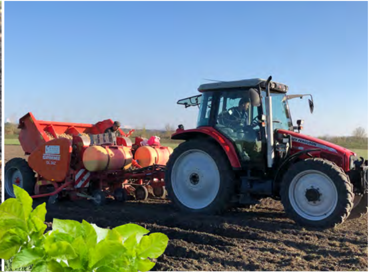
Mit der Kartoffellegemaschine werden gleichzeitig die Dämme gezogen und die Saatkartoffeln eingesetzt.
