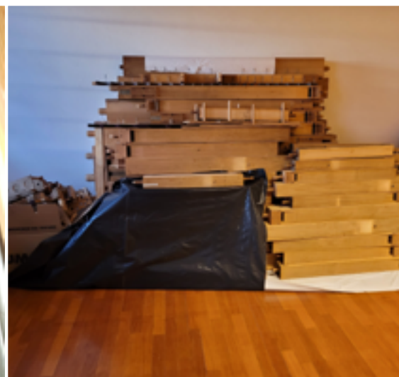
Teil für Teil wurde die Orgel auseinandergenommen, in Basel gereinigt und wieder zusammengesetzt. In der Mitte erhält man einen Eindruck des Zustands der Orgel nach dem Brand, auf dem rechten Bild liegen die bereits gereinigten Teile für den Wiedereinbau bereit.
